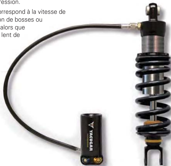
Molette de réglages hydrauliques en option pour les amortisseurs E-RS, F-RS, S-RS et S-RR.
